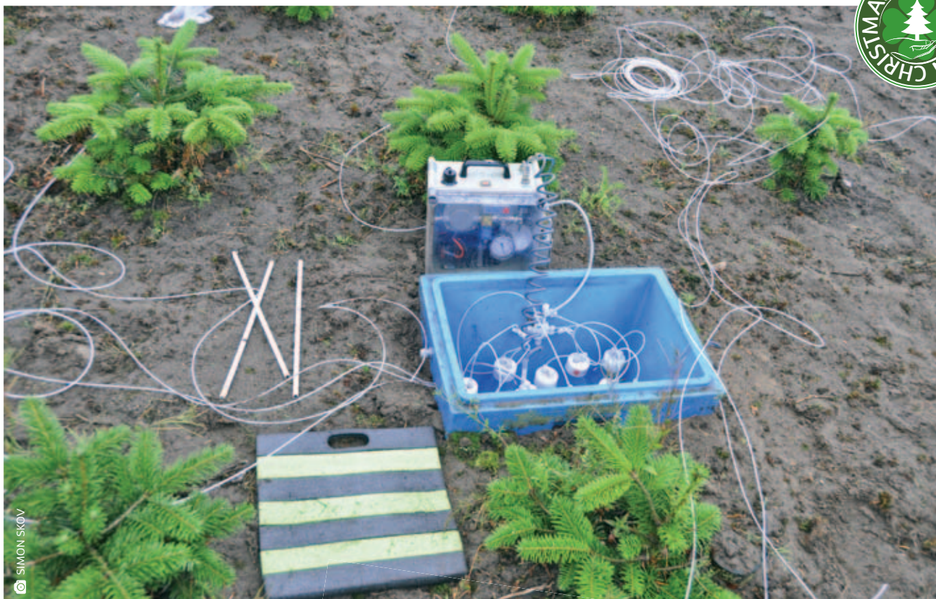
Etablering af jordvandsystem til indsamling af jordvæske. Systemet bruges til at bestemme tabet af næringsstoffer fra rodzonen. Der etableres et undertryk der suger jordvæsken fra jorden via tefloncoatede slanger ind i opsamlingsflasker, som står i nedgravede isolerede blå kasser.
